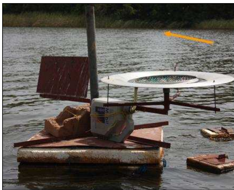
Figure 4.4 Collecteur de dépôt de poussière (Frisbee) sur Bangou Bi, la flèche la direction du vent (Photo : Mamane, 2009)
