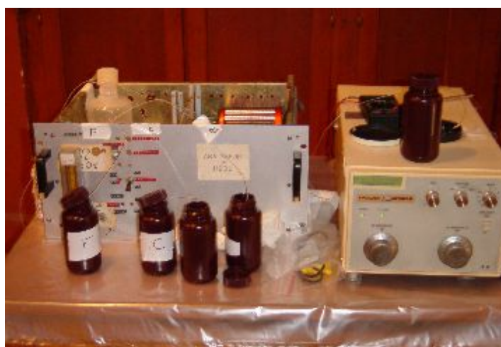
Figure 5-54 : Système de mesure du H 2 O 2
