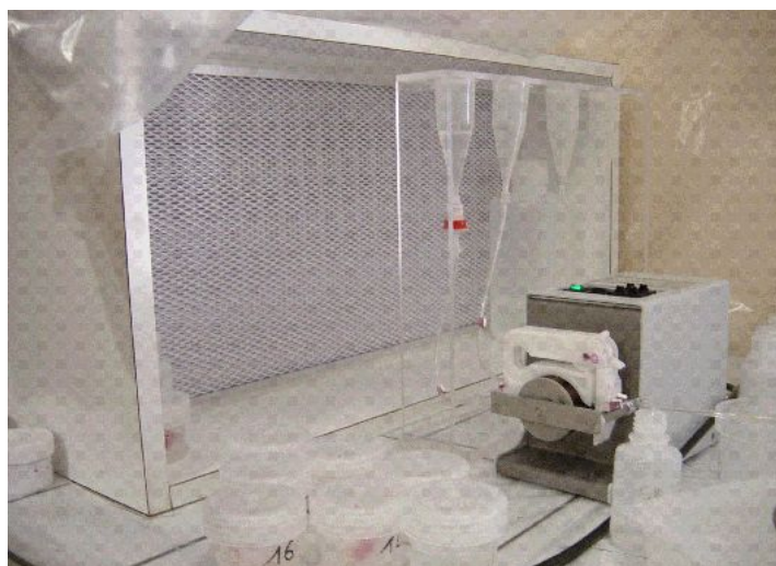
Figure 5-46 : Installation d'une hotte et système de séparation du Fe(II)/Fe(III)
