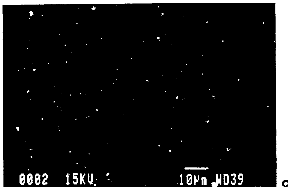
Figure 22 : Observations en Microscopie Electronique à Balayage (MEB) d'un filtre Nuclepore à différents stades de la préparation : (a) avant extraction de la matière ; (b) après 1 lavage et (c) après deux lavages.
